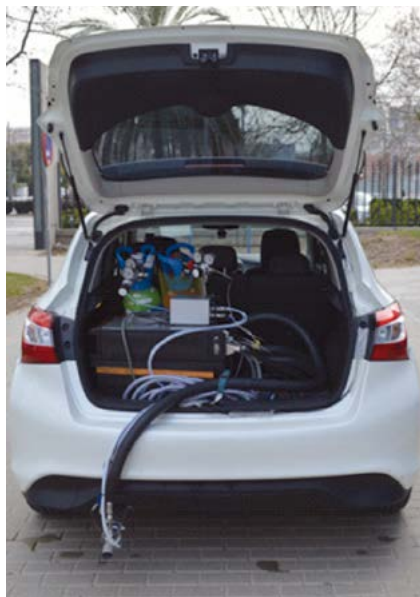
Figura 1. Nissan Pulsar con motor diésel K9K 1.5 dCi con el sistema portátil de medición de emisiones Horiba OBS-ONE-GS12.
