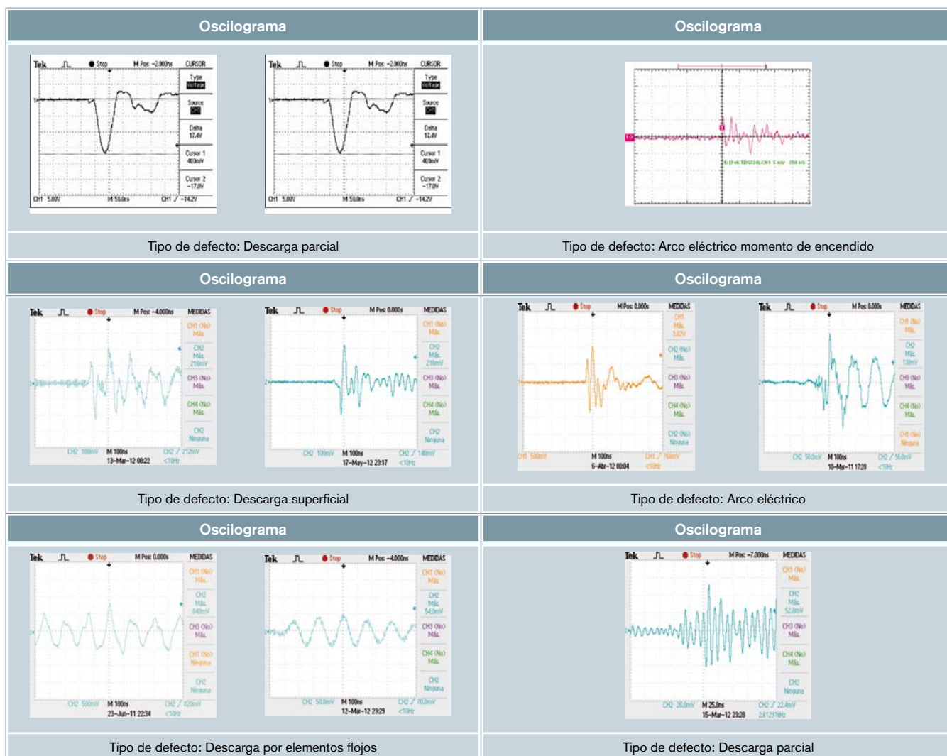
Figura 6. Oscilogramas de las señales asociadas a los defectos.
