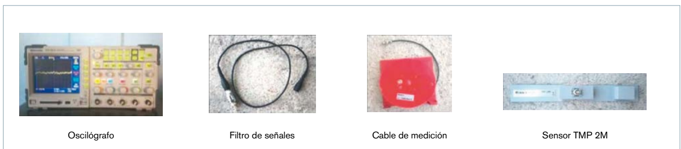
Figura 4. Equipos de medición para obtener los oscilogramas y localizar los defectos.
